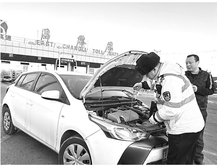
2月4日，一辆小型轿车行至秦滨高速昌黎东收费站时发动机故障灯亮起，提示缺少机油，司机遂向在此执勤的高速交警昌黎大队民警求助。民警经过仔细查看，待车辆发动机降温后，用随身携带的机油为故障车辆进行了补加。
