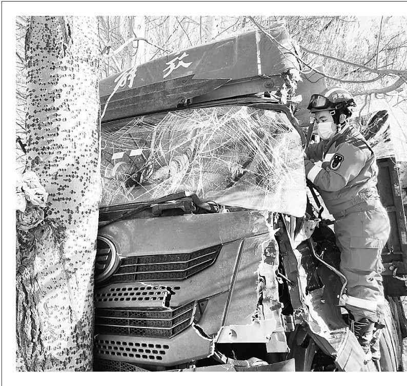
11月8日13时08分,张家口市消防救援支队指挥中心接到报警,称位于蔚县北水泉镇北马圈村附近109国道上一辆运载铁粉的半挂车车头与大树相撞,一人被困,情况危急,指挥中心立即调派蔚县消防救援大队出动。事故现场,被困人员双腿被变形的车头牢牢卡住,无法动弹。救援人员使用液压扩张器对受挤压变形的车体进行扩张,经过近10分钟的奋力营救,成功将被困人员救出并及时转移至现场120救护车,送往医院进行治疗。图为救援现场。
